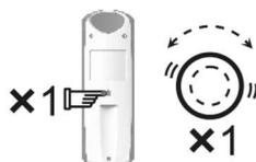
2) Appuyer 1 fois sur le bouton PROG en 10s, le moteur fait un va-et-vient
