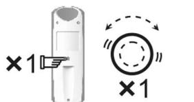
2) Appuyer 1 fois sur le bouton PROG en 10s, le moteur fait un va-et-vient
