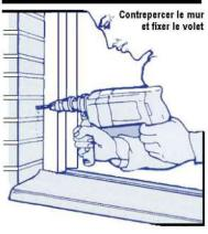
La serrure se trouve soit sur la lame finale (lame du bas), soit sur une lame intermédiaire. Il faut percer le fond des glissières à hauteur des tiges de serrure :
